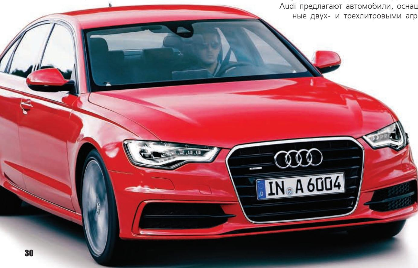
тами, мощностью, соответственно, 140 л.с. и 225 л.с. Фирменная полноприводная трансмиссия Quattro в сочетании с автоматической коробкой передач предлагается только для самых мощных модификаций. Базовые версии с моторами 2.0 TDI и 2.4 V6 – переднеприводные с механическими коробками. Как и прежде, в передней и задней подвесках используются вариации на тему двухрычажной схемы: спереди – четырехрычажная подвеска, сзади – трапециевидные рычаги.
